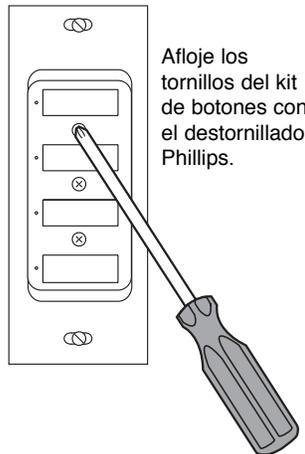
Afloje los tornillos del kit de botones con el destornillador Phillips.
