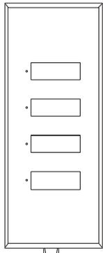
Usando la herramienta de desmontaje incluida, desmonte la placa frontal del teclado haciendo palanca con cuidado en la parte inferior.
