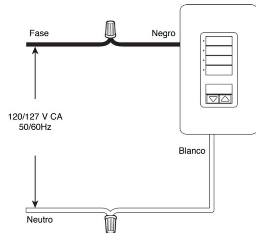
4. Empuje todos los cables al interior de la caja de empotrar y apriete ligeramente el control a la caja de empotrar con los tornillos que se incluyen. No pinche los cables.
